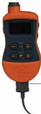
CHARGER CONNECTOR PLACED IN THE REMOTE TRANSMITTER CHARGING JACK
